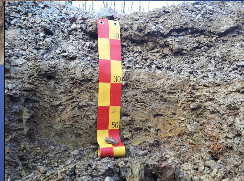
Rechts: Aufschluss der Probefläche mit Schotterauf- lage ohne Unterbodenstabilisation
